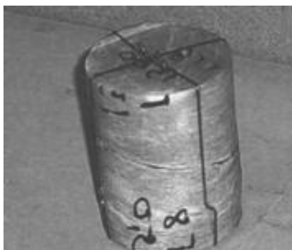
Σχήμα 3.18. Δοκίμιο βράχου όπου έχει προετοιμαστεί για καλούπωμα
