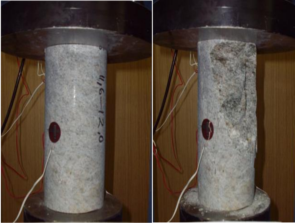
Σχήμα 4.9α Φωτογραφίες δοκιμίου #4 πριν και μετά τη δοκιμή stress-strain
