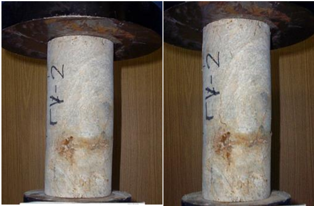
Σχήμα 4.4α Φωτογραφίες δοκιμίου #4 πριν και μετά τη δοκιμή μονοαξονικής θλίψης.
