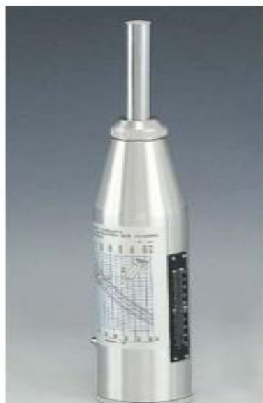
Σχήμα 3.14. Σφύρα Schmidt και παράδειγμα δοκιμής σε κυλινδρικό δοκίμιο πετρώματος
