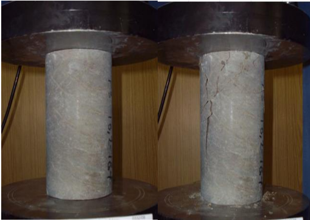
Σχήμα 4.3α Φωτογραφίες δοκιμίου #3 πριν και μετά τη δοκιμή μονοαξονικής θλίψης.
