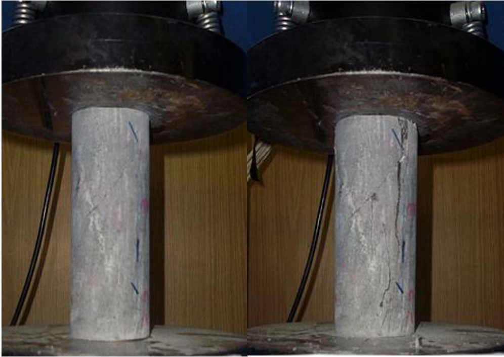
Σχήμα 4.5α Φωτογραφίες δοκιμίου #5 πριν και μετά τη δοκιμή μονοαξονικής θλίψης
