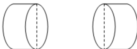
Σχήμα 3.13. Σχεδίαση μιας διαμετρικής γραμμής σε κάθε άκρο του δοκιμίου
