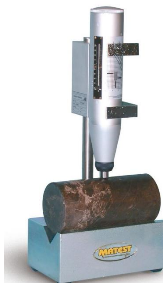
Σχήμα 3.14. Σφύρα Schmidt και παράδειγμα δοκιμής σε κυλινδρικό δοκίμιο πετρώματος
