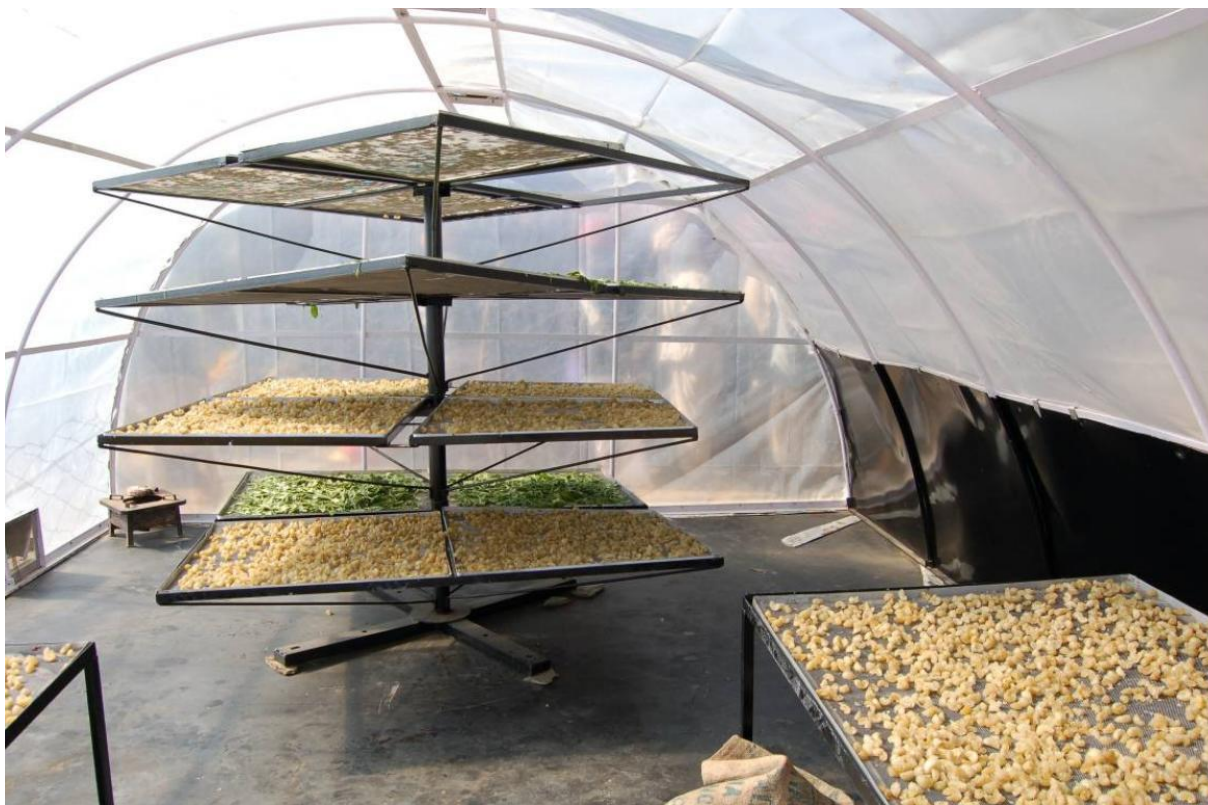
Εικόνα 3.3: Σύστημα έμμεσου ηλιακού ξηραντηρίου τροφίμων.
