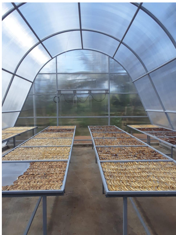
Εικόνα 3.1: Σύστημα ηλιακής ξήρανσης φρούτων, χρησιμοποιώντας ηλιακή ενέργεια και όχι ηλεκτρική ενέργεια, στην Ινδονησία
