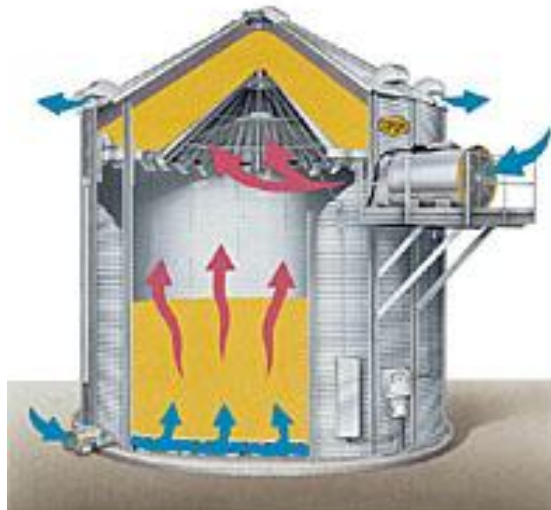
Εικόνα 3.9: Απεικόνιση λειτουργίας συστήματος ανάδευσης ηλιακής ξήρανσης κόκκων. [34]
