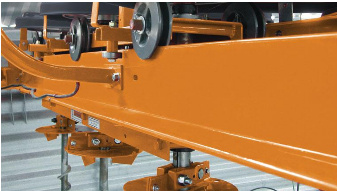
Εικόνα 3.7: Σύστημα ανάδευσης με κίνηση που αλλάζει τη διαδρομή των κοχλιών σε κάθε περιστροφή γύρω από τον κάδο. [32]
