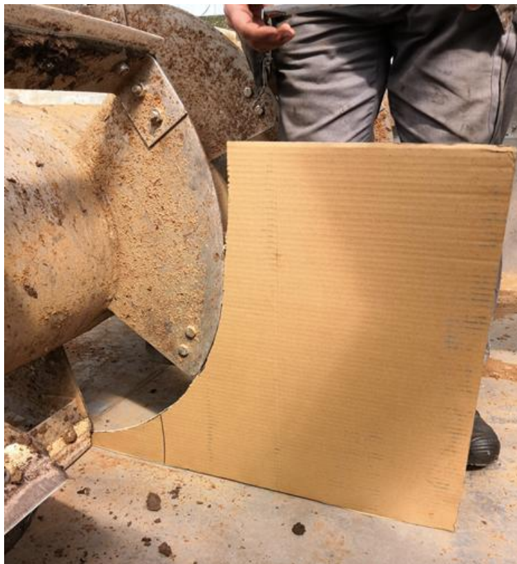
Εικόνα 4.29: Αποτύπωση εξωτερικής επιφάνειας κυλίνδρου σε χαρτόνι
