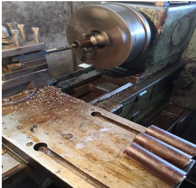
Εικόνα 4.25: Κατασκευή πείρου συγκράτησης με συμβατικό τόρνο
