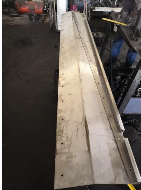
Εικόνα 4.33: Κατασκευή ανοξείδωτων πτυσσόμενων ξέστρων.
