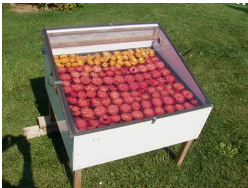
Εικόνα 3.2: Σύστημα άμεσου ηλιακού στεγνωτήρα λαχανικών.
