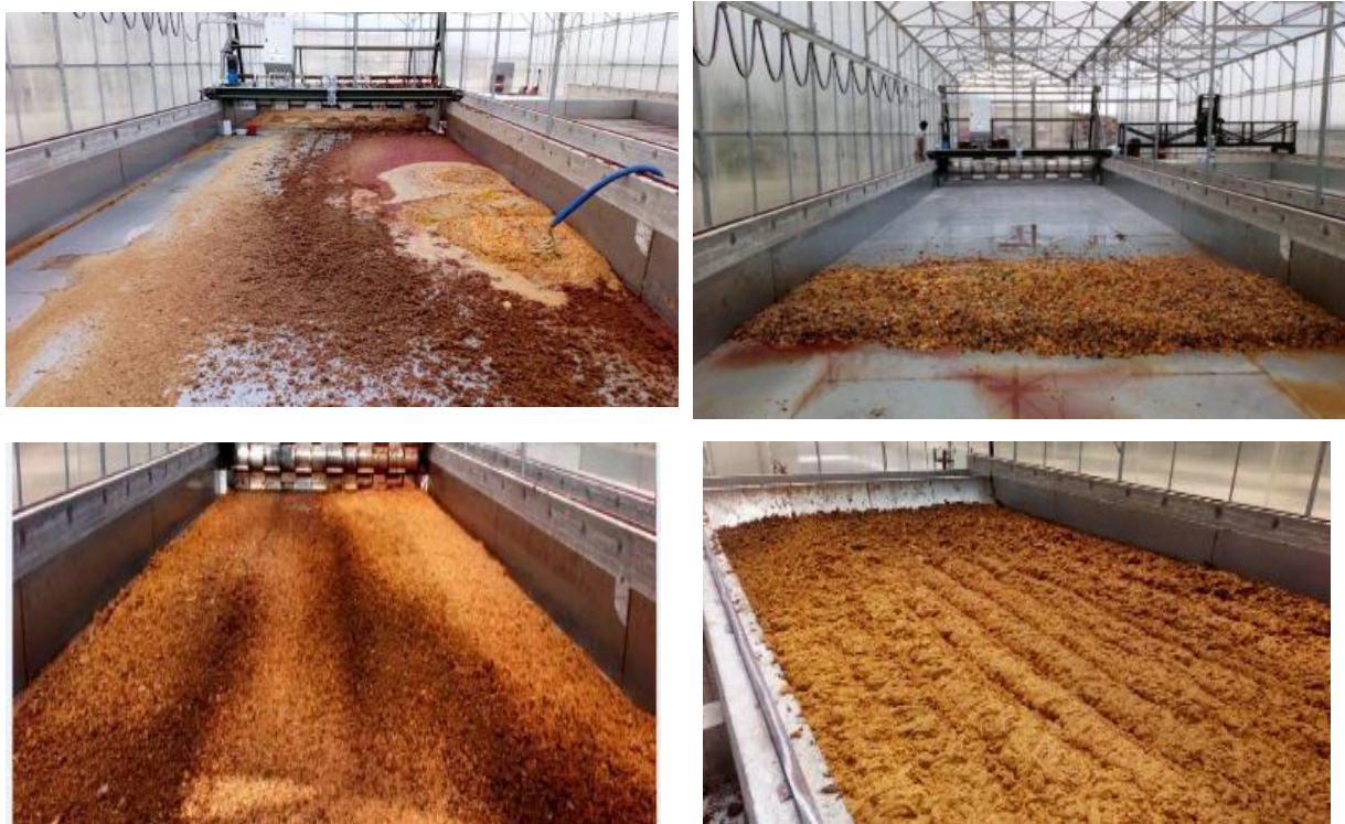
Εικόνα 4.7: Δεξαμενή ξήρανσης κατά τη διάρκεια ξήρανσης υλικών
