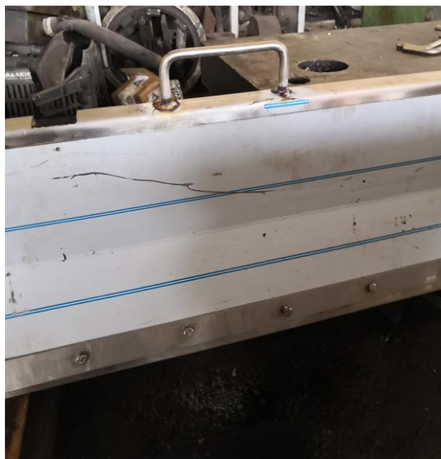
Εικόνα 4.36: Κατασκευή λαβών ανοξείδωτων πτυσσόμενων ξέστρων.
