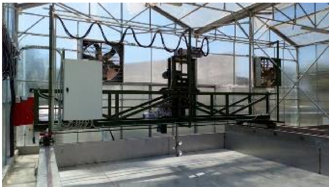
Εικόνα 4.6: Το σύστημα ξήρανσης με τον κατακόρυφο άξονα ανάδευσης της μονάδας ξήρανσης
