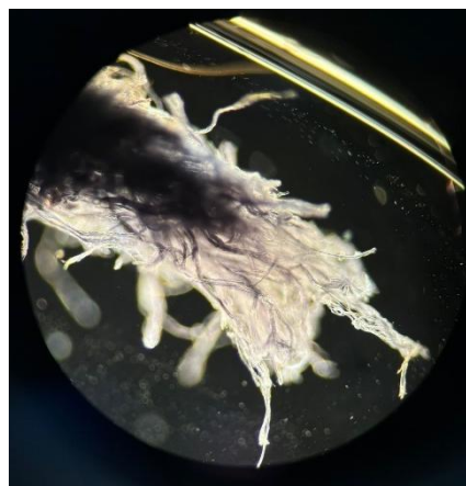
Εικόνα 2.26: Δερματίνη μαύρου χρώματος (30% PVC, 66% πολυουρεθάνη, 4% ελαστάν) σε οπτικό μικροσκόπιο με 100 φορές μεγέθυνση
