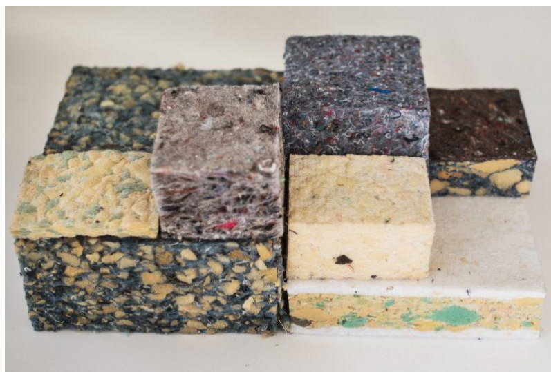
Εικόνα 6.5: Δείγματα διαφόρων ηχομονωτικών και θερμομονωτικών υλικών από κλωστοϋφαντουργικά προϊόντα [138]
