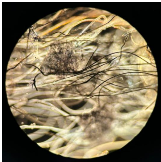
Εικόνα 2.27: Συνθετική εσωτερική επένδυση δερματίνης μαύρου χρώματος (50% πολυεστέρας, 50% πολυουρεθάνη) σε οπτικό μικροσκόπιο με 100 φορές μεγέθυνση.
