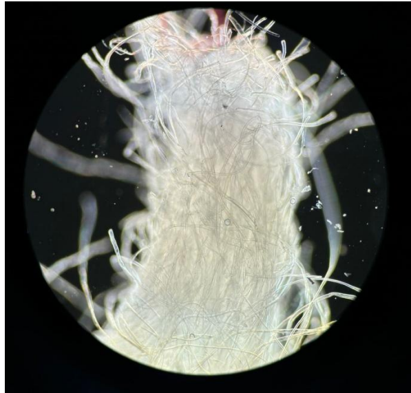
Εικόνα 2.13: Ύφασμα φυσικής προέλευσης από 100% βαμβάκι λευκού χρώματος σε οπτικό μικροσκόπιο με 100 φορές μεγέθυνση
