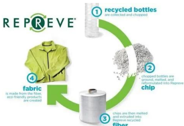
Εικόνα 6.10: Διαδικασία παραγωγής ρούχων από πλαστικό μπουκάλι [148]
