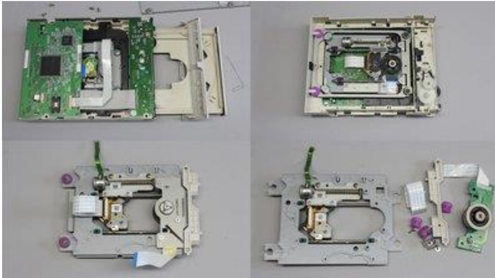
Εικόνα 58: Ανοιχτό CD-ROM με τελικό αποτέλεσμα αυτό που χρησιμοποιείται στην ανάπτυξη του 3Δ εκτυπωτή
