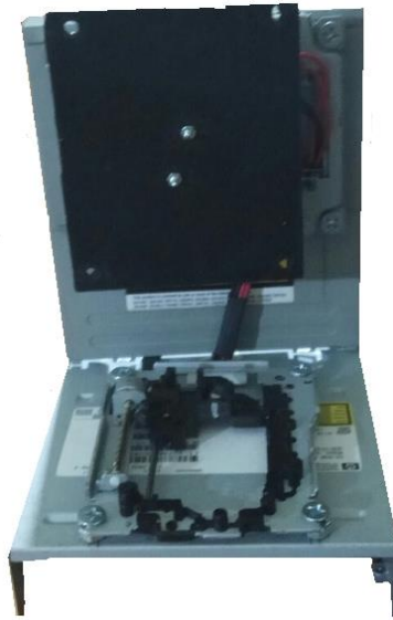
Εικόνα 62: Η ιδιοκατασκευή σε σχήμα L με τους X και Y άξονες
