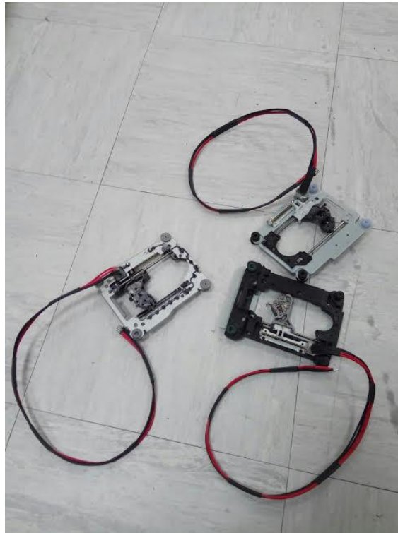
Εικόνα 60: Οι τρεις άξονες από CD-ROMs
