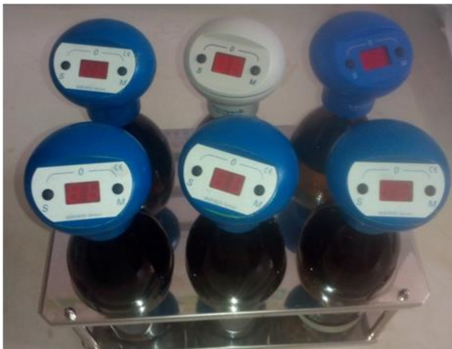
Εικόνα 6: Συσκευή BOD (Lovibond)
