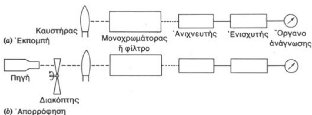
Εικόνα 5: Σχεδιάγραμμα λειτουργίας φλογοφωτόμετρου[32]
