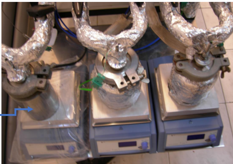
Σχήμα 4.3: Οι τρεις θάλαμοι bubbler του συστήματος APCVD του Κ.Ε.Τ.Υ.Φ. του Ελληνικού Μεσογειακού Πανεπιστημίου
