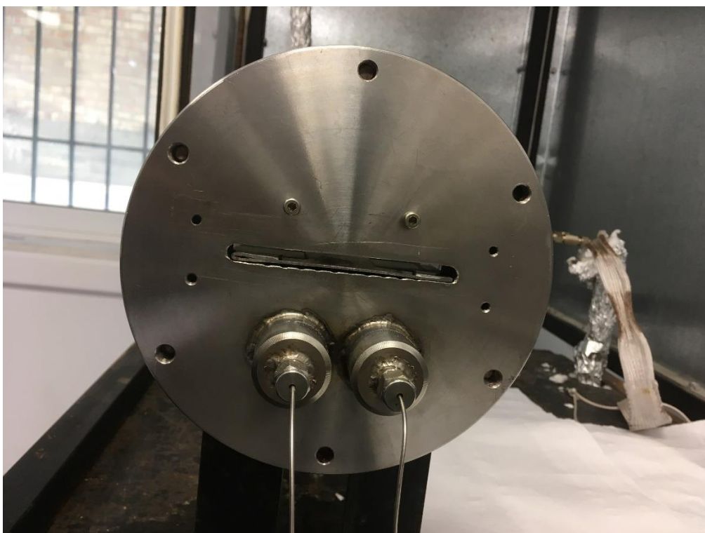
Σχήμα 5.3: Η είσοδος δειγμάτων του θαλάμου αντιδράσεων του συστήματος APCVD
