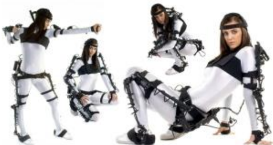
Εικ. 5: Μηχανική Καταγραφή Κίνησης
