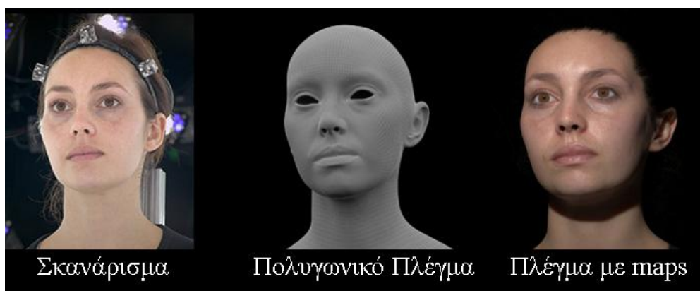
Εικ. 29: Μοντελοποίηση με Τρισδιάστατη Σάρωση
