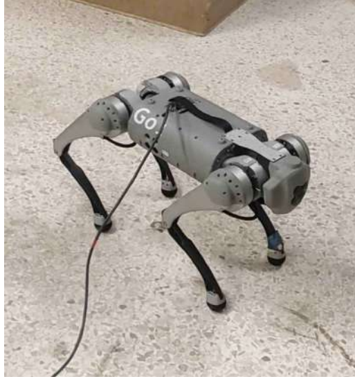
Σχήμα 2.1: Πειραματική διάταξη 1 ης προσέγγισης : Το ρομπότ Go1 συνδεδεμένο με ένα καλώδιο ethernet
