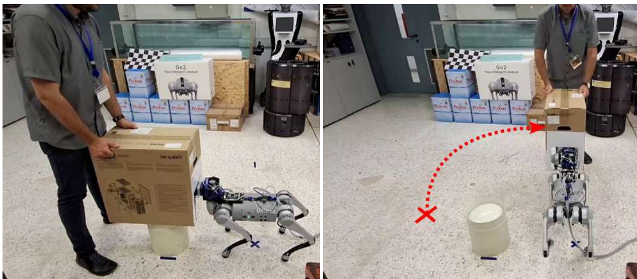
(α') Αρχική θέση του πειράματος που αφορά την κίνηση σε τόξο. (β') Τελική θέση του πειράματος που αφορά την κίνηση σε τόξο.
