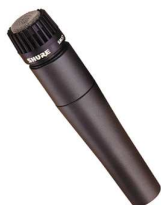
Φωτογραφία 7.2: Το SHURE SM57 ανήκει στη κατηγορία των «δυναμικών» μικροφώνων.
