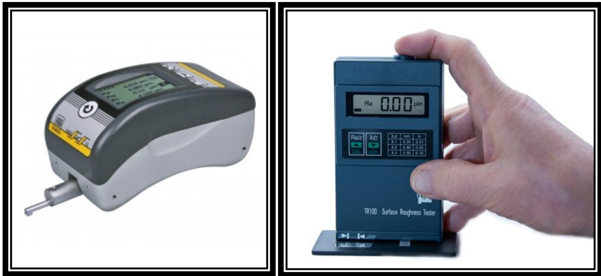
Σχήμα 1.7. Τυπικά ηλεκτρομηχανικά τραχύμετρα [10, 11]
