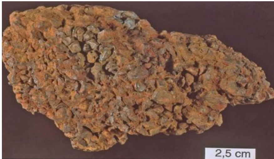
Εικόνα 2. Δείγμα λατεριτικού βωξίτη από το Σουδάν όπου διακρίνεται η χαρακτηριστική δομή κονδύλων και πisolίθων. (Πηγή: Orykta.gr- Κοιτασματολογία)
