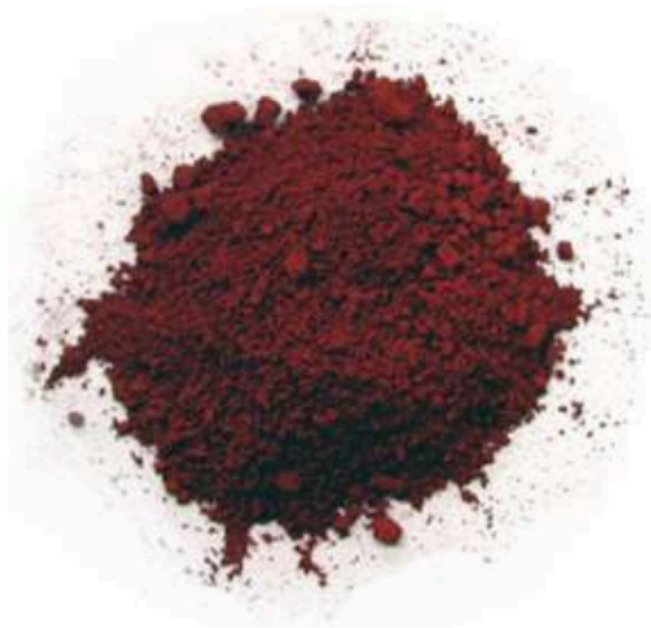
Εικόνα 13. Δείγμα ερυθρά ιλύος μετά από απομάκρυνση υγρασίας(Πηγή: Red mud project.com - "Characteristics")
