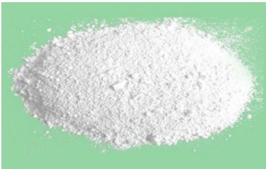
Εικόνα 11. Αλουμίνα μετά την κατεργασία που υπόκειται σε μορφή πούδρας(Πηγή: Orykta.gr- Κοιτασματολογία)
