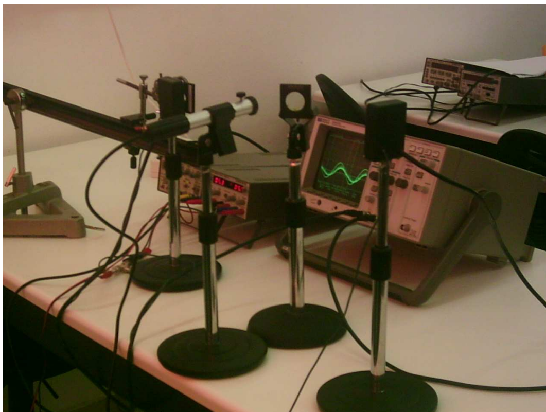
Σχήμα 3.2: Πειραματική διάταξη που χρησιμοποιήθηκε για την πειραματική μέτρηση της ταχύτητας του φωτός. Απεικονίζονται οι φωτοδιόδοι που χρησιμοποιήθηκαν, το διοδικό laser, το τροφοδοτικό και ο παλμογράφος.
