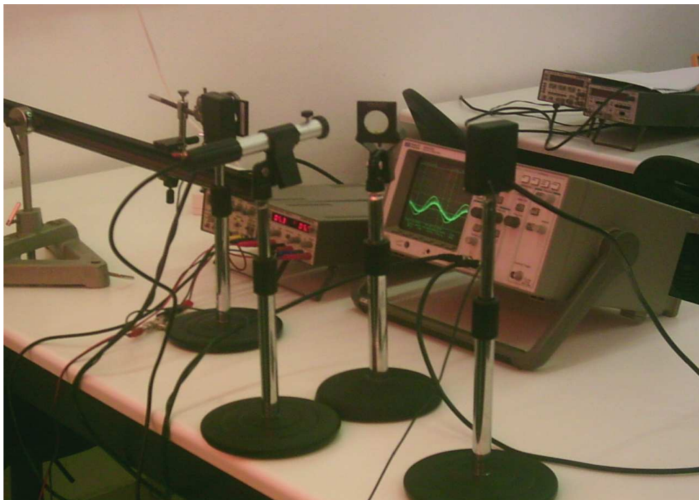
Σχήμα 1.4: οπτοηλεκτρονικό σύστημα που χρησιμοποιήθηκε για την μέτρηση της ταχύτητας του φωτός
