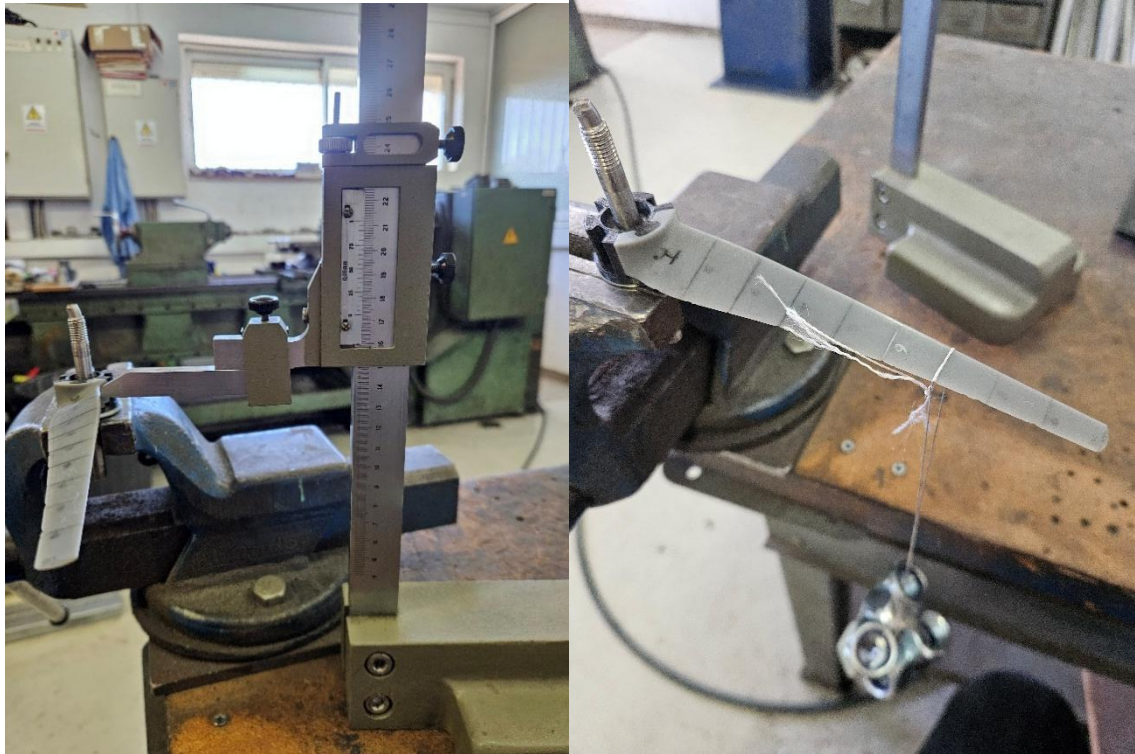
Εικόνα 81. Πειραματική διάταξη και διαδικασία μέτρησης της παραμόρφωσης του πτερυγίου.
