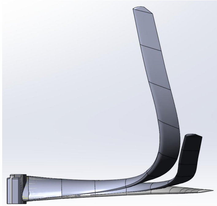
Εικόνα 133. Σύγκριση μη παραμορφωμένου και παραμορφωμένων πτερυγίων για ταχύτητες ανέμου 10 και 25 m/s (Πλάγια όψη).
