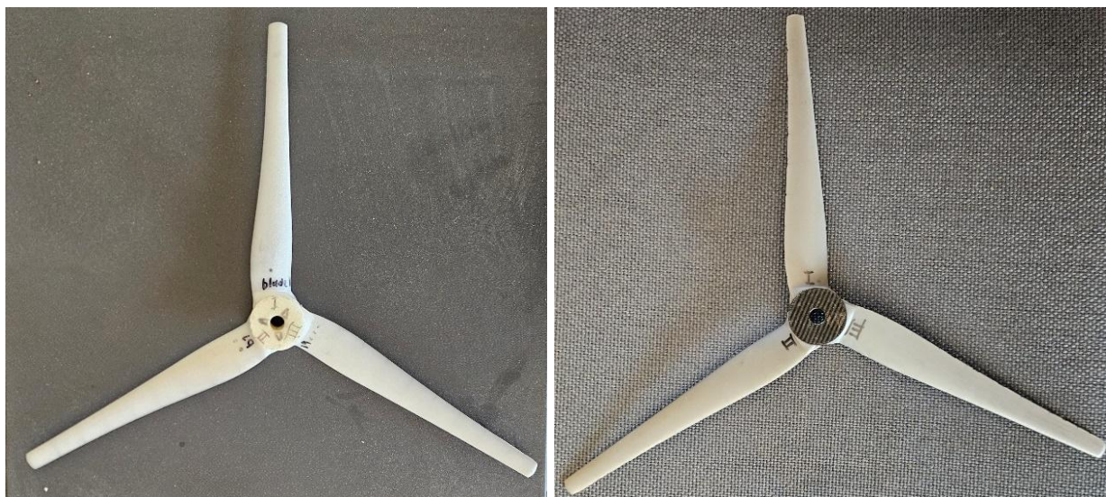
Εικόνα 43. Ευθύ πτερύγιο από HDPE (αριστερά) και ευθύ πτερύγιο από Tough 2000 (δεξιά).
