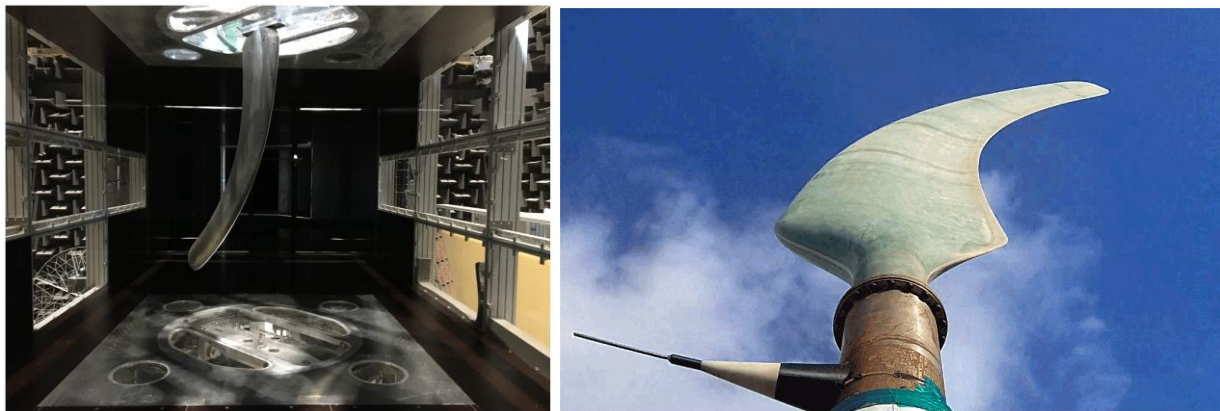
Εικόνα 30. Πειραματική διάταξη για δοκιμή ακροπερυγίου σε αεροσήραγγα (αριστερά) και υπαίθρια δοκιμή του καμπύλου ακροπερυγίου στο rotating rig του DTU (δεξιά).
