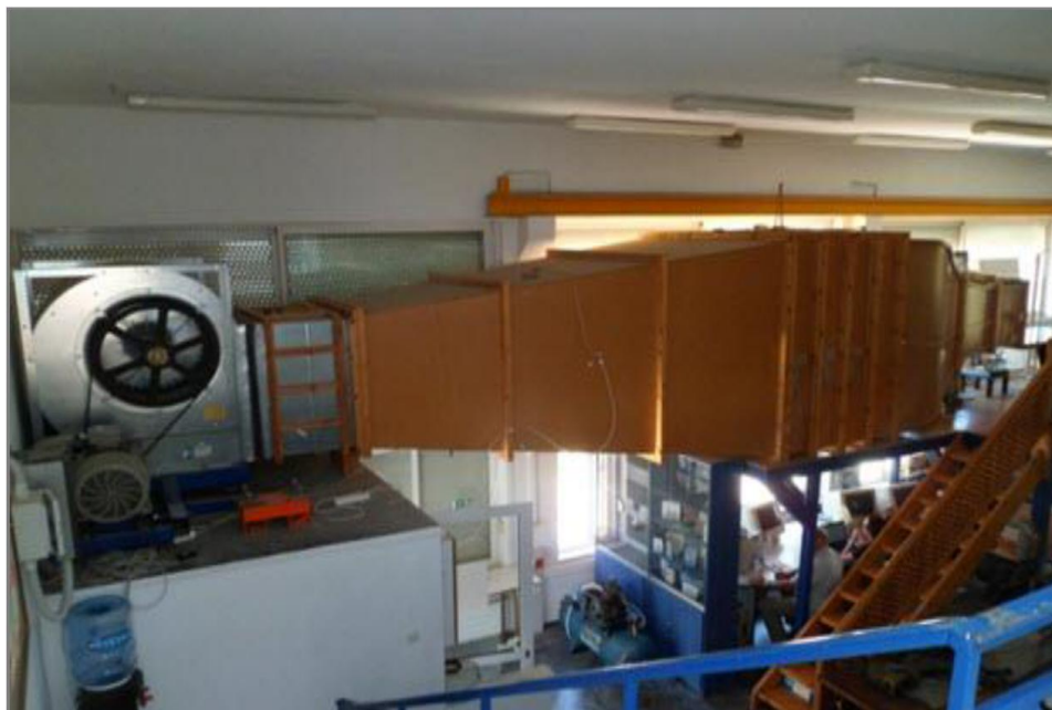
Εικόνα 40. Αεροσήραγγα εργαστηρίου αεροδυναμικών για πειραματικές δοκιμές πτερυγίων μικρής κλίμακας.
