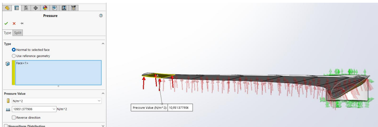
Εικόνα 98. Εφαρμογή φορτίων πίεσης στις επιφάνειες του πτερυγίου για τη στατική προσομοίωση.
